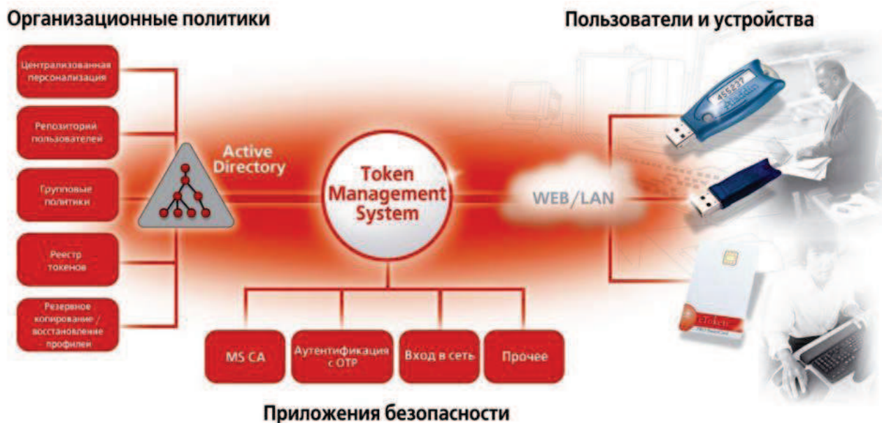
Рис. 31. Общая архитектура применения «eToken TMS»
