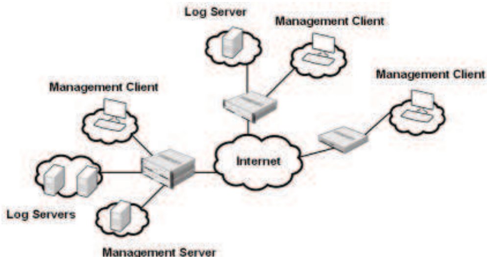
Рис. 20. Распределенная система управления
