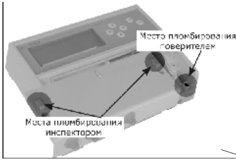
Схема пломбирования тепловычислителя
